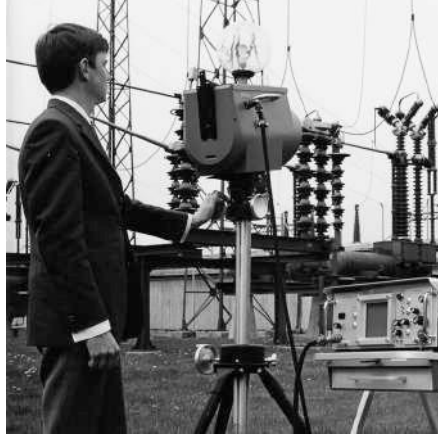
Şekil 27.2 1969: Thermovision Model 661. Kamera yaklaşık 25 kg (55 lb.), osiloskop 20 kg (44 lb.) ve tripod 15 kg (33 lb.) ağırlığındaydı. Operatörün ayrıca 220 VAC jeneratör setine ve içinde sıvı nitrojen bulunan 10 L'lik (2,6 ABD galonu) bir kavanoza ihtiyacı vardı. Osiloskobun solunda Polaroid eklentisi (6 kg/13 lb.) görülebilir.
